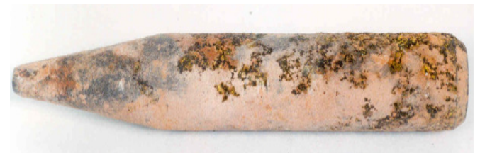
Ce pénétrateur d'UA a été retrouvé dans la rainure d'un mur. On voit une petite quantité d'oxydation de couleur jaune à la superficie. Cette oxydation se produit rapidement à température ambiante.
