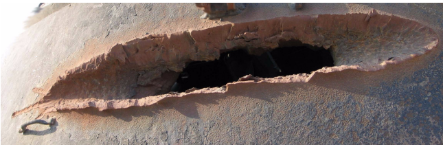
Au moment de l'impact d'un projectile sur un char, le pénétrateur d'UA commence à s'affiler lui-même en transperçant le blindage.
