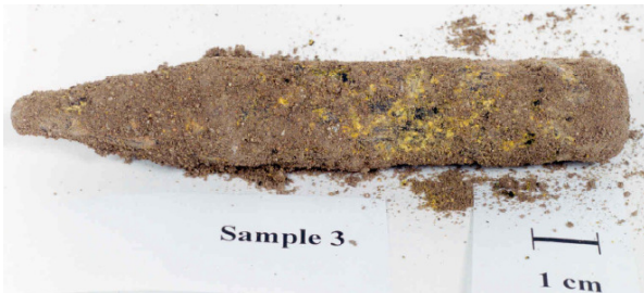
Ce pénétrateur à UA a été retrouvé à la surface du sol, couvert de débris et de neige. Il s'était consumé de façon grave et au toucher, des particules d'oxyde s'en détachaient.
