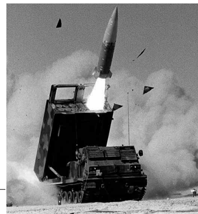
Le système MLRS lance un missile de type ATACMS Block 1, composé de 950 sous-munitions (Lockheed Martin)
