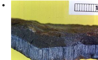
Amiante bleu (crocidolite) provenant de Wittenoom (Australie de l'Ouest). La règle mesure 1 cm
